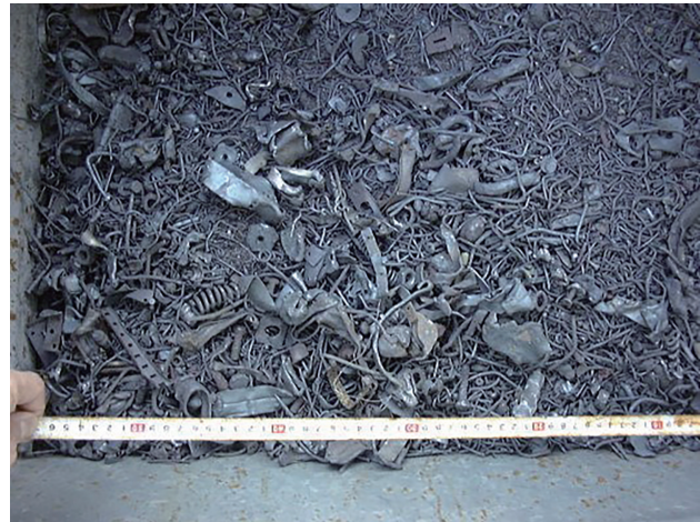
写真 2 CFB ボイラから排出された不燃性の異物 Photo 2 Incombustible impurities discharged from CFB boiler
